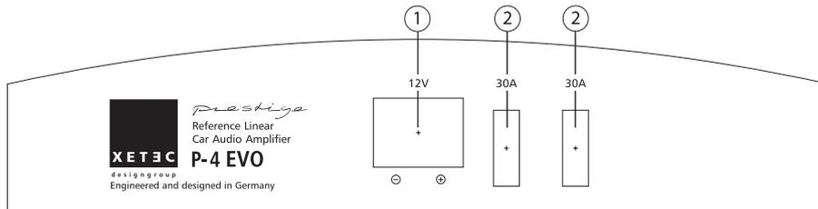
1. 12V Strom-Eingang: Stromanschluß für +12V und Masse (-) von der Fahrzeugbatterie
