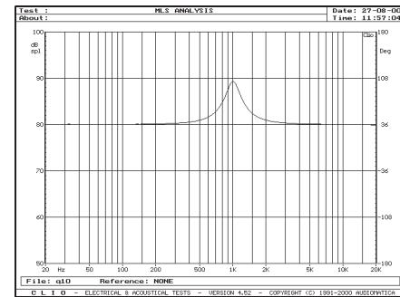
4. Parametric EQ:  $f=1000\text{Hz}$ ;  $Q=20$ ;  $G=+8\text{dB}$
