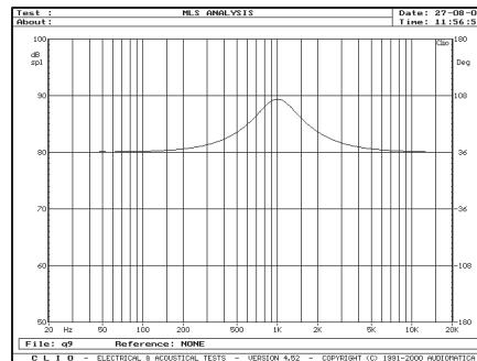
3. Parametric EQ:  $f=1000\text{Hz}$ ;  $Q=5,0$ ;  $G=+8\text{dB}$
