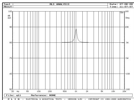
5. Parametric EQ:  $f=1000\text{Hz}$ ;  $Q=20$ ;  $G=-8\text{dB}$
