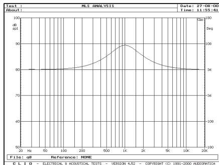
2. Parametric EQ:  $f=1000\text{Hz}$ ;  $Q=1,0$ ;  $G=+8\text{dB}$
